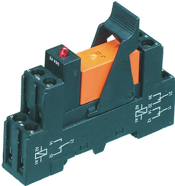
Vormontiertes Relaismodul PRS..., Schraubanschluss, bestehend aus: Relaissockel, Relais mit Mehrlagen-Goldkontakt, steckbarem Anzeige-/ Entstörmodul und Haltebügel, 2 Wechsler, Eingangsspannung: 24 VDC
