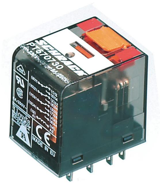
Steckbare Industrirelais, mit Mehrlagen-Goldkontakt, 4 Wechsler, Prüftaste, mechanische Schaltstellungsanzeige, Polarität A1+, A2-, Eingangsspannung: 24 VDC
