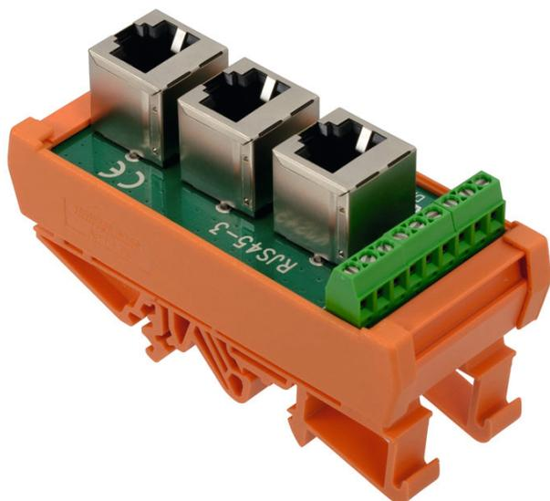
Übergabemodul für RJ45, geschirmt, CAT 3, Schraubanschluss und 3x RJ45-Steckverbinder, Montageart: TS 35, Polzahl: 9
