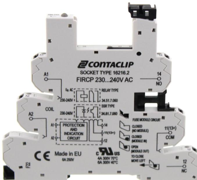
Interface-Relais-Compact (IRC) Stecksocket FIRCP P mit Push-in-Anschluss, Montageart: TS 35, 1 Wechsler, Eingangsspannung: 230 bis 240 VAC
