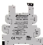
Interface-Relais-Compact (IRC) Stecksocket FIRC mit Push-in-Anschluss, Montageart: TS 35, 1 Wechsler, Eingangsspannung: 230 bis 240 VAC
