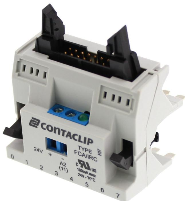
Steckanschlussadapter für Interface-Relais-Compact (IRC), Flachband Steckverbinder 14-polig nach IEC 60603-13 auf 8 Relaiskanäle, Plusschaltend, Nennspannung: 24 VDC
