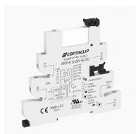
Interface-Relais-Compact (IRC) Komplett, bestehend aus Sockel IRCP... mit Schraubanschluss und steckbarem Miniaturrelais PRC... mit Leistungskontakt, Montageart: TS 35, 1 Wechsler, Eingangsspannung: 240 VAC
