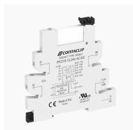
Interface-Relais-Compact (IRC) Komplett, bestehend aus Sockel IRCO... mit Schraubanschluss und steckbarem Miniaturrelais PRC... mit Leistungskontakt, Montageart: TS 35, 1 Wechsler, Eingangsspannung: 6 VAC/DC
