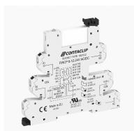
Interface-Relais-Compact (IRC) Komplett, bestehend aus Sockel FIRCP... mit Push-in-Anschluss und steckbarem Miniaturrelais mit Leistungskontakt, Montageart: TS 35, 1 Wechsler, Eingangsspannung: 125 VDC
