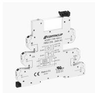
Interface-Relais-Compact (IRC) Komplett, bestehend aus Sockel FIRCI... mit Push-in-Anschluss und steckbarem Miniaturrelais mit Leistungskontakt, Montageart: TS 35, 1 Wechsler, Eingangsspannung: 240 VAC
