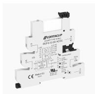
Interface-Relais-Compact (IRC) Komplett, bestehend aus Sockel IRCP... mit Schraubanschluss und steckbarem Miniaturrelais PRC... mit Leistungskontakt, Montageart: TS 35, 1 Wechsler, Eingangsspannung: 220 VDC
