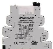
Interface-Relais-Compact (IRC) Komplett, bestehend aus Sockel FIRC... mit Push-in-Anschluss und steckbarem Miniaturrelais mit Leistungskontakt, Montageart: TS 35, 1 Wechsler, Eingangsspannung: 24 VAC/DC
