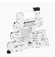
Interface-Relais-Compact (IRC) Stecksocket FIRC P mit Push-in-Anschluss, Montageart: TS 35, 1 Wechsler, Eingangsspannung: 110 bis 125 VDC
