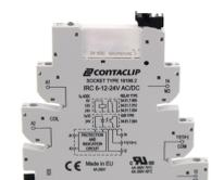
Interface-Relais-Compact (IRC) Komplett, bestehend aus Sockel IRC... mit Schraubanschluss und steckbarem Miniaturrelais PRC... mit Leistungskontakt, Montageart: TS 35, 1 Wechsler, Eingangsspannung: 24 VAC/DC
