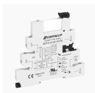
Interface-Relais-Compact (IRC) Komplett, bestehend aus Sockel IRCP... mit Schraubanschluss und steckbarem Miniaturrelais PRC... mit Leistungskontakt, Montageart: TS 35, 1 Wechsler, Eingangsspannung: 125 VDC
