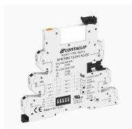
Multifunktions-Zeitrelais-Baustein, Interface-Relais-Compact (IRC) Komplett, bestehend aus Sockel MFR-FIRCP... mit Push-in-Anschluss und steckbarem Miniaturrelais PRC... mit Leistungskontakt, Montageart: TS 35, 1 Wechsler, Eingangsspannung: 24 VAC/DC
