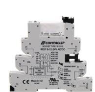
Interface-Relais-Compact (IRC) Komplett, bestehend aus Sockel IRCP... mit Schraubanschluss und steckbarem Miniaturrelais PRC... mit Leistungskontakt, Montageart: TS 35, 1 Wechsler, Eingangsspannung: 24 VAC/DC
