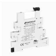
Interface-Relais-Compact (IRC) Stecksocket IRCO mit Schraubanschluss, Montageart: TS 35, 1 Wechsler, Eingangsspannung: 110 bis 125 VAC/DC
