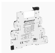
Interface-Relais-Compact (IRC) Komplett, bestehend aus Sockel FIRC... mit Push-in-Anschluss und steckbarem Miniaturrelais mit Leistungskontakt, Montageart: TS 35, 1 Wechsler, Eingangsspannung: 12 VAC/DC
