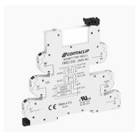
Interface-Relais-Compact (IRC) Komplett, bestehend aus Sockel FIRCI... mit Push-in-Anschluss und steckbarem Miniaturrelais mit Leistungskontakt, Montageart: TS 35, 1 Wechsler, Eingangsspannung: 125 VAC/DC
