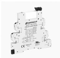
Interface-Relais-Compact (IRC) Stecksocket FIRC mit Push-in-Anschluss, Montageart: TS 35, 1 Wechsler, Eingangsspannung: 110 bis 125 VAC/DC
