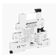
Interface-Relais-Compact (IRC) Komplett, bestehend aus Sockel IRCP... mit Schraubanschluss und steckbarem Miniaturrelais PRC... mit Leistungskontakt, Montageart: TS 35, 1 Wechsler, Eingangsspannung: 6 VAC/DC
