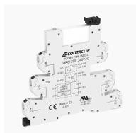
Interface-Relais-Compact (IRC) Komplett, bestehend aus Sockel FIRCI... mit Push-in-Anschluss und steckbarem Miniaturrelais mit Leistungskontakt, Montageart: TS 35, 1 Wechsler, Eingangsspannung: 12 VAC/DC
