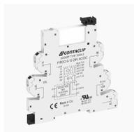
Interface-Relais-Compact (IRC) Komplett, bestehend aus Sockel FIRCO... mit Push-in-Anschluss und steckbarem Miniaturrelais mit Leistungskontakt, Montageart: TS 35, 1 Wechsler, Eingangsspannung: 6 VAC/DC
