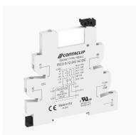
Interface-Relais-Compact (IRC) Komplett, bestehend aus Sockel IRCO... mit Schraubanschluss und steckbarem Miniaturrelais PRC... mit Leistungskontakt, Montageart: TS 35, 1 Wechsler, Eingangsspannung: 24 VAC/DC
