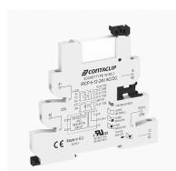
Interface-Relais-Compact (IRC) Stecksocket IRCP mit Schraubanschluss und Reststromunterdrückung für lange Leitungswege, Montageart: TS 35, 1 Wechsler, Eingangsspannung: 230 bis 240 VAC/DC
