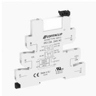
Interface-Relais-Compact (IRC) Komplett, bestehend aus Sockel IRCI... mit Schraubanschluss und steckbarem Miniaturrelais PRC... mit Leistungskontakt, Montageart: TS 35, 1 Wechsler, Eingangsspannung: 6 VAC/DC
