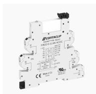
Interface-Relais-Compact (IRC) Komplett, bestehend aus Sockel FIRCO... mit Push-in-Anschluss und steckbarem Miniaturrelais mit Leistungskontakt, Montageart: TS 35, 1 Wechsler, Eingangsspannung: 12 VAC/DC
