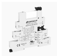
Interface-Relais-Compact (IRC) Komplett, bestehend aus Sockel IRCP... mit Schraubanschluss und steckbarem Miniaturrelais PRC... mit Leistungskontakt, Montageart: TS 35, 1 Wechsler, Eingangsspannung: 125 VAC/DC
