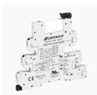
Interface-Relais-Compact (IRC) Komplett, bestehend aus Sockel FIRCP... mit Push-in-Anschluss und steckbarem Miniaturrelais mit Leistungskontakt, Montageart: TS 35, 1 Wechsler, Eingangsspannung: 125 VAC/DC
