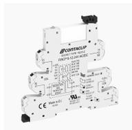
Interface-Relais-Compact (IRC) Komplett, bestehend aus Sockel FIRCP... mit Push-in-Anschluss und steckbarem Miniaturrelais mit Leistungskontakt, Montageart: TS 35, 1 Wechsler, Eingangsspannung: 240 VAC
