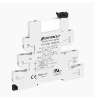
Interface-Relais-Compact (IRC) Stecksocket IRCI mit Schraubanschluss, Montageart: TS 35, 1 Wechsler, Eingangsspannung: 110 bis 125 VAC/DC
