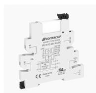
Interface-Relais-Compact (IRC) Komplett, bestehend aus Sockel IRC... mit Schraubanschluss und steckbarem Miniaturrelais PRC... mit Leistungskontakt, Montageart: TS 35, 1 Wechsler, Eingangsspannung: 12 VAC/DC
