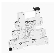
Interface-Relais-Compact (IRC) Komplett, bestehend aus Sockel FIRCI... mit Push-in-Anschluss und steckbarem Miniaturrelais mit Leistungskontakt, Montageart: TS 35, 1 Wechsler, Eingangsspannung: 6 VAC/DC
