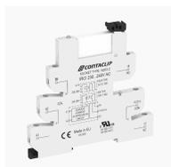
Interface-Relais-Compact (IRC) Komplett, bestehend aus Sockel IRCI... mit Schraubanschluss und steckbarem Miniaturrelais PRC... mit Leistungskontakt, Montageart: TS 35, 1 Wechsler, Eingangsspannung: 24 VAC/DC
