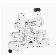
Interface-Relais-Compact (IRC) Stecksocket FIRC P mit Push-in-Anschluss, Montageart: TS 35, 1 Wechsler, Eingangsspannung: 60 VAC/DC
