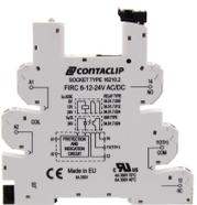
Interface-Relais-Compact (IRC) Stecksocket FIRC mit Push-in-Anschluss, Montageart: TS 35, 1 Wechsler, Eingangsspannung: 6,12 oder 24 VAC/DC
