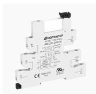
Interface-Relais-Compact (IRC) Komplett, bestehend aus Sockel IRCI... mit Schraubanschluss und steckbarem Miniaturrelais PRC... mit Leistungskontakt, Montageart: TS 35, 1 Wechsler, Eingangsspannung: 240 VAC
