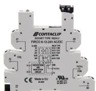
Interface-Relais-Compact (IRC) Stecksocket FIRC O mit Push-in-Anschluss, Montageart: TS 35, 1 Wechsler, Eingangsspannung: 6,12 oder 24 VAC/DC
