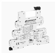
Interface-Relais-Compact (IRC) Komplett, bestehend aus Sockel FIRCP... mit Push-in-Anschluss und steckbarem Miniaturrelais mit Leistungskontakt, Montageart: TS 35, 1 Wechsler, Eingangsspannung: 220 VDC
