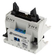
Steckanschlussadapter für Interface-Relais-Compact (IRC), Flachband Steckverbinder 14-poilig nach IEC 60603-13 auf 8 Relaiskanäle, Pluschaltend, Nennspannung: 24 VDC
