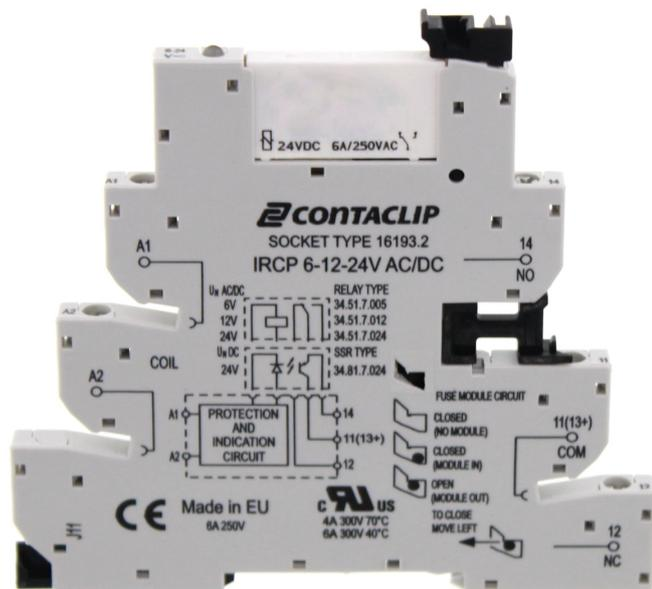
Interface-Relais-Compact (IRC) Komplett, bestehend aus Sockel IRCPU... mit Schraubanschluss und steckbarem Miniaturrelais PRC... mit Leistungskontakt, Montageart: TS 35, 1 Wechsler, Eingangsspannung: 24 VAC/DC
