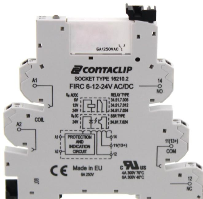
Interface-Relais-Compact (IRC) Komplett, bestehend aus Sockel FIRC... mit Push-in-Anschluss und steckbarem Miniaturrelais mit Leistungskontakt, Montageart: TS 35, 1 Wechsler, Eingangsspannung: 24 VAC/DC
