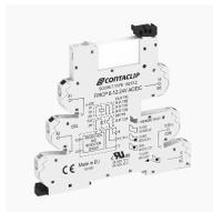
Interface-Relais-Compact (IRC) Stecksocket FIRC P mit Push-in-Anschluss, Montageart: TS 35, 1 Wechsler, Eingangsspannung: 110 bis 125 VDC
