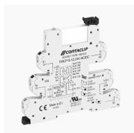
Interface-Relais-Compact (IRC) Stecksocket FIRC P mit Push-in-Anschluss und Reststromunterdrückung für lange Leitungswege, Montageart: TS 35, 1 Wechsler, Eingangsspannung: 110 bis 125 VAC/DC
