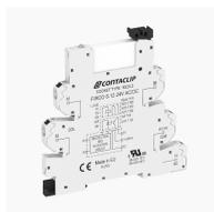
Interface-Relais-Compact (IRC) Komplett, bestehend aus Sockel FIRCO... mit Push-in-Anschluss und steckbarem Miniaturrelais mit Leistungskontakt, Montageart: TS 35, 1 Wechsler, Eingangsspannung: 125 VAC/DC
