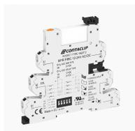
Multifunktions-Zeitrelais-Baustein, Interface-Relais-Compact (IRC) Komplett, bestehend aus Sockel MFR-FIRCP... mit Push-in-Anschluss und steckbarem Miniaturrelais PRC... mit Leistungskontakt, Montageart: TS 35, 1 Wechsler, Eingangsspannung: 12 VAC/DC
