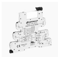
Interface-Relais-Compact (IRC) Komplett, bestehend aus Sockel FIRCP... mit Push-in-Anschluss und steckbarem Miniaturrelais mit Leistungskontakt, Montageart: TS 35, 1 Wechsler, Eingangsspannung: 24 VAC/DC
