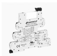
Interface-Relais-Compact (IRC) Komplett, bestehend aus Sockel FIRCP... mit Push-in-Anschluss und steckbarem Miniaturrelais mit Leistungskontakt, Montageart: TS 35, 1 Wechsler, Eingangsspannung: 60 VAC/DC
