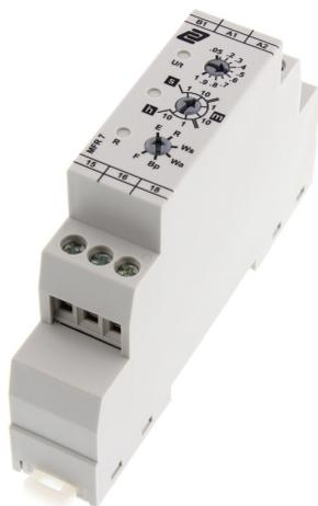
Multifunktions-Zeitrelais-Baustein mit 7 Funktionen, Steuerkontakt und einem einstellbaren Zeitbereich (50 ms - 10 h), Schraubanschluss, Montageart: TS 35, 1 Wechsler
