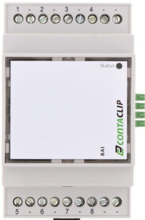
GSM-PRO I/O Analog-Eingangs-Modul, 8 Analog-Eingänge 0 - 10V, 0(4) - 20mA, NTC, RTD (PT1000/Ni1000),
