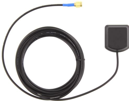
Kombinierte Mobilfunk-GPS-Antenne mit Rundstrahlcharakteristik, SMA-Rundstecker (GSM/UMTS) und R-SMA-Rundstecker (GPS), Anschlusskabellänge 3 m
