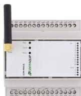
Kompaktes Meldesystem für Mobilfunknetze (bis einschließlich 4G), um analoge und digitale Werte zu überwachen sowie Relaisausgänge aus der Ferne zu schalten, Montageart: TS 35, Versorgungsspannungsbereich: 10 - 30 VDC.
