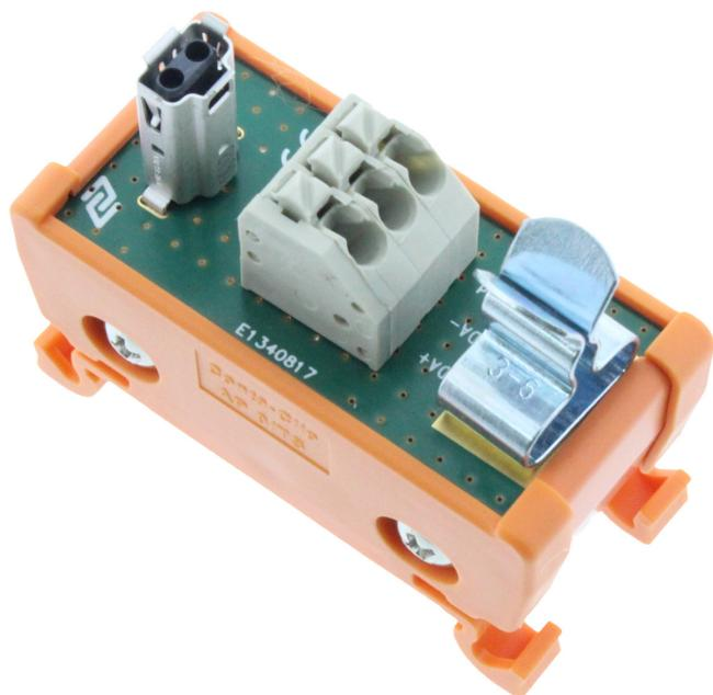
Übergabemodul für SPE (single pair ethernet), geschirmt, Push-in-Anschluss und SPE Steckverbinder, Montageart: TS 35, Polzahl: 2
