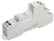
Relais-Stecksocket PPRS, für Miniatur-Leistungserelais mit 2-Wechslern, Push-in Anschluss, Steckmöglichkeit für Eingangs-/Entstörmodule und Querverbinder, Montageart: TS 35, Bemessungsquerschnitt: 1,5mm<sup>2</sup>, Bemessungsspannung 300V
