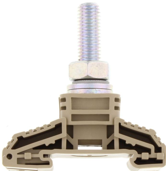
Hochstrom-Bolzenklemme, Bolzenanschluss, Montageart: TS 35/7,5, Bemessungsquerschnitt: 120 mm<sup>2</sup>,
