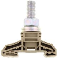
Hochstrom-Bolzenklemme, Bolzenanschluss, Montageart: TS 35/7,5,
