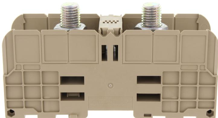
Hochstrom-Bolzenklemme, Bolzenanschluss, Montageart: TS 35/7,5, Bemessungsquerschnitt: 300 mm<sup>2</sup>, Breite: 55 mm, Farbe: Beige
