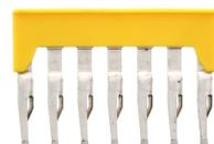
Querverbinder isoliert, Polzahl: 7, Montageart: Stecken, Breite: 34,6 mm, Bemessungsquerschnitt: 2,5 mm<sup>2</sup>, Farbe: Gelb
