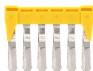
Querverbinder isoliert, Polzahl: 6, Montageart: Stecken, Breite: 30,3 mm, Bemessungsquerschnitt: 2,5 mm<sup>2</sup>, Farbe: Gelb
