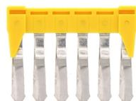
Querverbinder isoliert, Polzahl: 6, Montageart: Stecken, Breite: 30,3 mm, Bemessungsquerschnitt: 2,5 mm<sup>2</sup>, Farbe: Gelb
