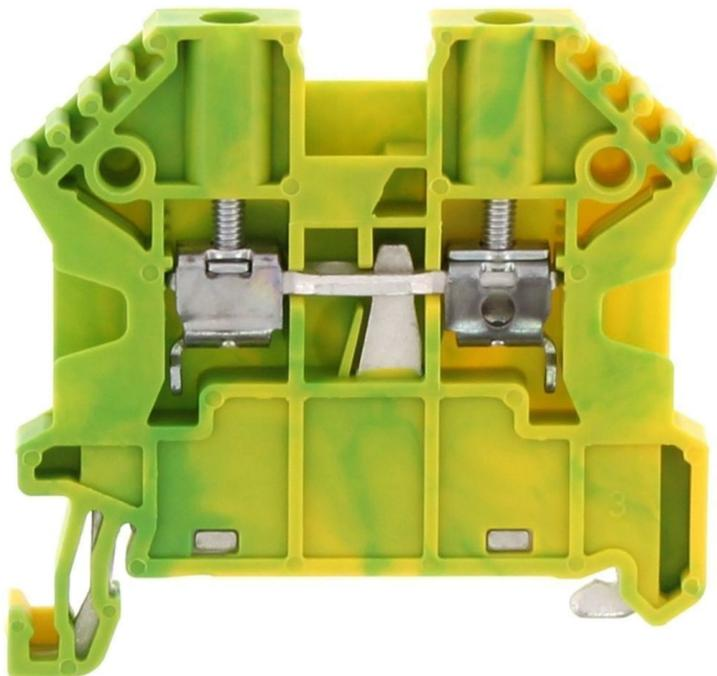
Schutzleiterklemme, Schraubanschluss, Montageart: TS 35/7,5, Bemessungsquerschnitt: 2,5 mm<sup>2</sup>, Breite: 5 mm, Farbe: Grün-gelb
