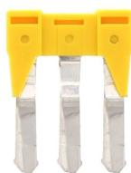
Querverbinder isoliert, Polzahl: 3, Montageart: Stecken, Breite: 17,4 mm, Bemessungsquerschnitt: 4 mm<sup>2</sup>, Farbe: Gelb
