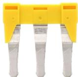
Querverbinder isoliert, Polzahl: 3, Montageart: Stecken, Breite: 22,4 mm, Bemessungsquerschnitt: 6 mm<sup>2</sup>, Farbe: Gelb
