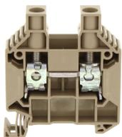
Durchgangsklemme, Schraubanschluss, Montageart: TS 35/7,5, Bemessungsquerschnitt: 16 mm<sup>2</sup>, Breite: 12,1 mm, Farbe: Beige
