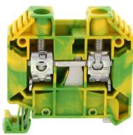
Schutzleiterklemme, Schraubanschluss, Montageart: TS 35/7,5, Bemessungsquerschnitt: 16 mm<sup>2</sup>, Breite: 10 mm, Farbe: Grün-gelb
