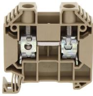
Durchgangsklemme, Schraubanschluss, Montageart: TS 35/7,5, Bemessungsquerschnitt: 16 mm<sup>2</sup>, Breite: 12,1 mm, Farbe: Beige
