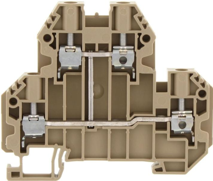
Doppelstockklemme, Schraubanschluss, Montageart: TS 35/7,5, Bemessungsquerschnitt: 4 mm<sup>2</sup>, Breite: 6,1 mm, Farbe: Beige
