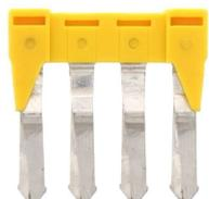
Querverbinder isoliert, Polzahl: 4, Montageart: Stecken, Breite: 23,5 mm, Bemessungsquerschnitt: 4 mm<sup>2</sup>, Farbe: Gelb
