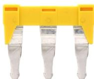
Querverbinder isoliert, Polzahl: 3, Montageart: Stecken, Breite: 27,6 mm, Bemessungsquerschnitt: 10 mm<sup>2</sup>, Farbe: Gelb
