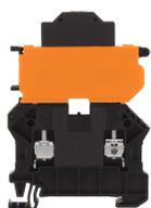
Sicherungstrennklemme, Schraubanschluss, Montageart: TS 35/7,5, Bemessungsquerschnitt: 4 mm<sup>2</sup>, Breite: 6,1 mm, Farbe: Schwarz
