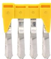
Querverbinder isoliert, Polzahl: 4, Montageart: Stecken, Breite: 20,1 mm, Bemessungsquerschnitt: 2,5 mm<sup>2</sup>, Farbe: Gelb
