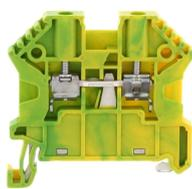
Schutzleiterklemme, Schraubanschluss, Montageart: TS 35/7,5, Bemessungsquerschnitt: 2,5 mm<sup>2</sup>, Breite: 5 mm, Farbe: Grün-gelb
