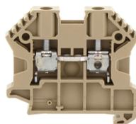
Durchgangsklemme, Schraubanschluss, Montageart: TS 35/7,5, Bemessungsquerschnitt: 2,5 mm<sup>2</sup>, Breite: 5 mm, Farbe: Beige
