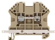
Durchgangsklemme, Schraubanschluss, Montageart: TS 35/7,5, Bemessungsquerschnitt: 2,5 mm<sup>2</sup>, Breite: 5 mm, Farbe: Beige
