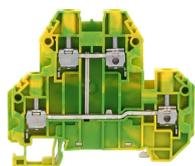
Schutzleiter-Doppelstockklemme, Schraubanschluss, Montageart: TS 35/7,5, Bemessungsquerschnitt: 4 mm<sup>2</sup>, Breite: 6,1 mm, Farbe: Grün-gelb
