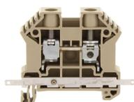
Durchgangsklemme, Schraubanschluss, Montageart: TS 35/7,5, Bemessungsquerschnitt: 16 mm<sup>2</sup>, Breite: 10 mm, Farbe: Beige
