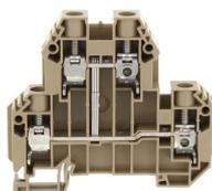
Doppelstockklemme, Schraubanschluss, Montageart: TS 35/7,5, Bemessungsquerschnitt: 10 mm<sup>2</sup>, Breite: 10,1 mm, Farbe: Beige
