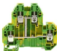
Schutzleiter-Doppelstockklemme, Schraubanschluss, Montageart: TS 35/7,5, Bemessungsquerschnitt: 10 mm<sup>2</sup>, Breite: 10,1 mm, Farbe: Grün-gelb
