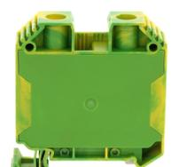
Schutzleiterklemme, Schraubanschluss, Montageart: TS 35/7,5, Bemessungsquerschnitt: 35 mm<sup>2</sup>, Breite: 16,1 mm, Farbe: Grün-gelb
