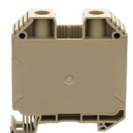
Durchgangsklemme, Schraubanschluss, Montageart: TS 35/7,5, Bemessungsquerschnitt: 35 mm<sup>2</sup>, Breite: 16,1 mm, Farbe: Beige
