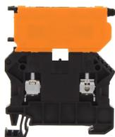
Sicherungstrennklemme, Schraubanschluss, Montageart: TS 35/7,5, Bemessungsquerschnitt: 4 mm<sup>2</sup>, Breite: 6,1 mm, Farbe: Schwarz
