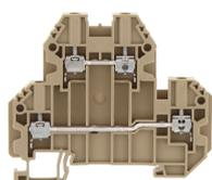
Doppelstockklemme, Schraubanschluss, Montageart: TS 35/7,5, Bemessungsquerschnitt: 2,5 mm<sup>2</sup>, Breite: 5,1 mm, Farbe: Beige
