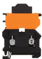
Sicherungstrennklemme, Schraubanschluss, Montageart: TS 35/7,5, Bemessungsquerschnitt: 6 mm<sup>2</sup>, Breite: 8,1 mm, Farbe: Schwarz
