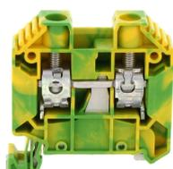
Schutzleiterklemme, Schraubanschluss, Montageart: TS 35/7,5, Bemessungsquerschnitt: 16 mm<sup>2</sup>, Breite: 12,1 mm, Farbe: Grün-gelb
