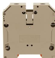
Durchgangsklemme, Schraubanschluss, Montageart: TS 35/7,5, Bemessungsquerschnitt: 70 mm<sup>2</sup>, Breite: 20,5 mm, Farbe: Beige
