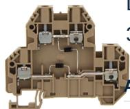
Doppelstockklemme mit elektronischen Bauteilen, Schraubanschluss, Montageart: TS 35/7,5, Bemessungsquerschnitt: 4 mm<sup>2</sup>, Breite: 6,1 mm, Farbe: Beige
