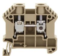
Durchgangsklemme, Schraubanschluss, Montageart: TS 35/7,5, Bemessungsquerschnitt: 16 mm<sup>2</sup>, Breite: 10 mm, Farbe: Beige
