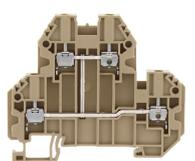
Doppelstockklemme, Schraubanschluss, Montageart: TS 35/7,5, Bemessungsquerschnitt: 2,5 mm<sup>2</sup>, Breite: 5,1 mm, Farbe: Beige
