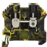
Durchgangsklemme, Schraubanschluss, Montageart: TS 35/7,5, Bemessungsquerschnitt: 16 mm<sup>2</sup>, Breite: 10 mm, Farbe: Schwarz-gelb
