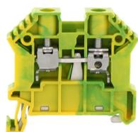
Schutzleiterklemme, Schraubanschluss, Montageart: TS 35/7,5, Bemessungsquerschnitt: 10 mm<sup>2</sup>, Breite: 8 mm, Farbe: Grün-gelb
