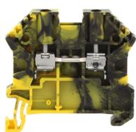
Durchgangsklemme, Schraubanschluss, Montageart: TS 35/7,5, Bemessungsquerschnitt: 2,5 mm<sup>2</sup>, Breite: 5 mm, Farbe: Schwarz-gelb
