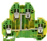
Schutzleiter-Doppelstockklemme, Schraubanschluss, Montageart: TS 35/7,5, Bemessungsquerschnitt: 10 mm<sup>2</sup>, Breite: 10,1 mm, Farbe: Grün-gelb
