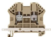
Durchgangsklemme, Schraubanschluss, Montageart: TS 35/7,5, Bemessungsquerschnitt: 4 mm<sup>2</sup>, Breite: 6 mm, Farbe: Beige
