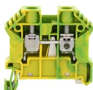
Schutzleiterklemme, Schraubanschluss, Montageart: TS 35/7,5, Bemessungsquerschnitt: 16 mm<sup>2</sup>, Breite: 10 mm, Farbe: Grün-gelb
