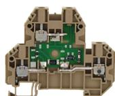
Doppelstockklemme mit elektronischen Bauteilen, Schraubanschluss, Montageart: TS 35/7,5, Bemessungsquerschnitt: 4 mm<sup>2</sup>, Breite: 6,1 mm, Farbe: Beige
