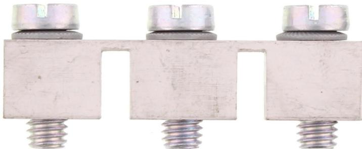
Querverbinder, Polzahl: 3, Montageart: Schraubbar, Breite: 49,2 mm, Bemessungsquerschnitt: 50 mm<sup>2</sup>,
