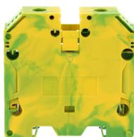
Schutzleiterklemme, Schraubanschluss, Montageart: TS 35/7,5, Bemessungsquerschnitt: 50 mm<sup>2</sup>, Breite: 18,5 mm, Farbe: Grün-gelb
