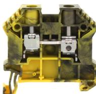
Durchgangsklemme, Schraubanschluss, Montageart: TS 35/7,5, Bemessungsquerschnitt: 10 mm<sup>2</sup>, Breite: 8 mm, Farbe: Schwarz-gelb
