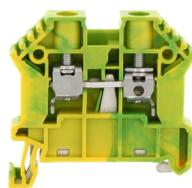
Schutzleiterklemme, Schraubanschluss, Montageart: TS 35/7,5, Bemessungsquerschnitt: 10 mm<sup>2</sup>, Breite: 8 mm, Farbe: Grün-gelb
