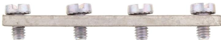
Querverbinder, Polzahl: 4, Montageart: Schraubbar, Breite: 57 mm, Bemessungsquerschnitt: 35 mm<sup>2</sup>, Farbe: Natur
