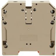
Durchgangsklemme, Schraubanschluss, Montageart: TS 35/7,5, Bemessungsquerschnitt: 120 mm<sup>2</sup>, Breite: 27 mm, Farbe: Beige
