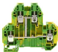
Schutzleiter-Doppelstockklemme, Schraubanschluss, Montageart: TS 35/7,5,
