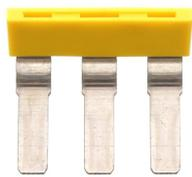
Außenquerverbinder isoliert, Polzahl: 3, Montageart: Stecken, Breite: 28,2 mm, Bemessungsstrom: 57 A, Farbe: Gelb
