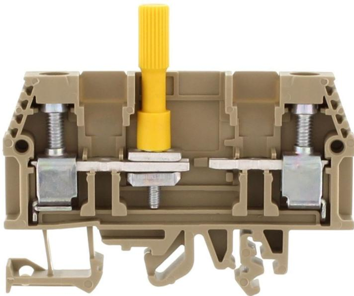
Prüftrennklemme, Schraubanschluss, Montageart: TS 35/7,5 und TS 32, Bemessungsquerschnitt: 10 mm<sup>2</sup>, Breite: 8 mm, Farbe: Beige
