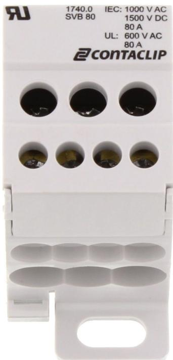
Schraub-Verteiler-Block, Schraubanschluss, Montageart: TS 35/7,5 und Montagefläche, Bemessungsquerschnitt Eingang: 16 mm<sup>2</sup>, Bemessungsquerschnitt Ausgang: 6 und 16 mm<sup>2</sup>, Farbe: Lichtgrau
