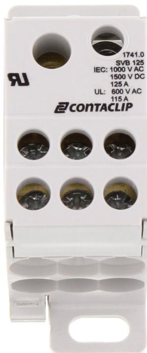
Schraub-Verteiler-Block, Schraubanschluss, Montageart: TS 35/7,5 und Montagefläche, Bemessungsquerschnitt Eingang: 16 und 35 mm<sup>2</sup>, Bemessungsquerschnitt Ausgang: 16 mm<sup>2</sup>, Farbe: Lichtgrau
