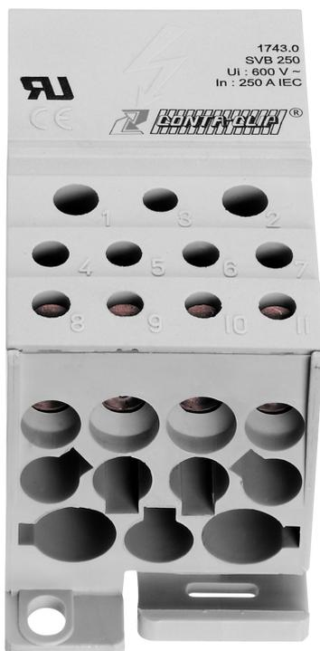
Schraub-Verteiler-Block, Schraubanschluss, Montageart: TS 35/7,5 und Montagefläche, Bemessungsquerschnitt Eingang: 120 mm<sup>2</sup>, Bemessungsquerschnitt Ausgang: 10, 16 und 35 mm<sup>2</sup>, Farbe: Lichtgrau
