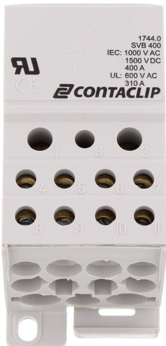
Schraub-Verteiler-Block, Schraubanschluss, Montageart: TS 35/7,5 und Montagefläche, Bemessungsquerschnitt Eingang: 185 mm<sup>2</sup>, Bemessungsquerschnitt Ausgang: 10, 16 und 35 mm<sup>2</sup>, Farbe: Lichtgrau
