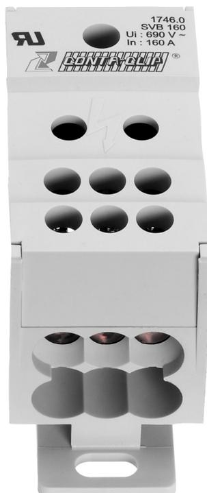
Schraub-Verteiler-Block, Schraubanschluss, Montageart: TS 35/7,5 und Montagefläche, Bemessungsquerschnitt Eingang: 70 mm<sup>2</sup>, Bemessungsquerschnitt Ausgang: 16 mm<sup>2</sup>, Farbe: Lichtgrau
