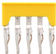
Querverbinder isoliert, Polzahl: 5, Montageart: Stecken, Breite: 24,4 mm, Bemessungsquerschnitt: 2,5 mm<sup>2</sup>, Farbe: Gelb
