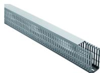
Verdrahtungskanal inklusive Deckel, Montageart: Nieten, Breite: 40 mm, Höhe: 80 mm, Material: PVC-U, Farbe: Grau
