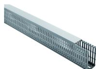
Verdrahtungskanal inklusive Deckel, Montageart: Nieten, Breite: 40 mm, Höhe: 40 mm, Material: PVC-U, Farbe: Grau
