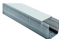
Verdrahtungskanal inklusive Deckel, Montageart: Nieten, Breite: 60 mm, Höhe: 80 mm, Material: PVC-U, Farbe: Grau
