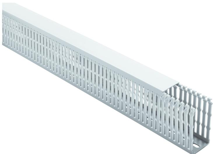
Verdrahtungskanal inklusive Deckel, Montageart: Nieten, Breite: 40 mm, Höhe: 60 mm, Material: PC-ABS, Farbe: Lichtgrau
