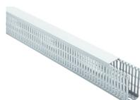
Verdrahtungskanal inklusive Deckel, Montageart: Nieten, Breite: 40 mm, Höhe: 100 mm, Material: PC-ABS, Farbe: Lichtgrau
