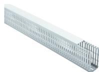
Verdrahtungskanal inklusive Deckel, Montageart: Nieten, Breite: 40 mm, Höhe: 80 mm, Material: PC-ABS, Farbe: Lichtgrau
