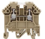
Reihen-klemme für Temperaturmesskreise, Schraubanschluss, Montageart: TS 35/7,5 und TS 32, Bemessungsquerschnitt: 2,5 mm<sup>2</sup>, Breite: 10 mm, Farbe: Beige
