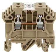
Reihenklemme für Temperaturmesskreise, Schraubanschluss, Montageart: TS 35/7,5 und TS 32, Bemessungsquerschnitt: 2,5 mm<sup>2</sup>, Breite: 10 mm, Farbe: Beige
