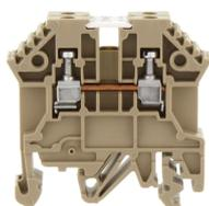
Reihenklemme für Temperaturmesskreise, Schraubanschluss, Montageart: TS 35/7,5 und TS 32, Bemessungsquerschnitt: 2,5 mm<sup>2</sup>, Breite: 10 mm, Farbe: Beige
