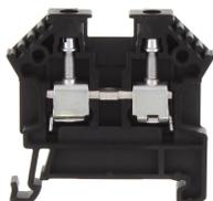
Durchgangsklemme, Schraubanschluss, Montageart: TS 35/7,5, Bemessungsquerschnitt: 4 mm<sup>2</sup>, Breite: 6 mm, Farbe: Schwarz
