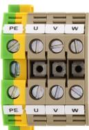
Vierleiter-Motor-Anschlussblock, Schraubanschluss, Montageart: TS 35/7,5 und TS 32, Bemessungsquerschnitt: 10 mm<sup>2</sup>, Farbe: Mehrfarbig
